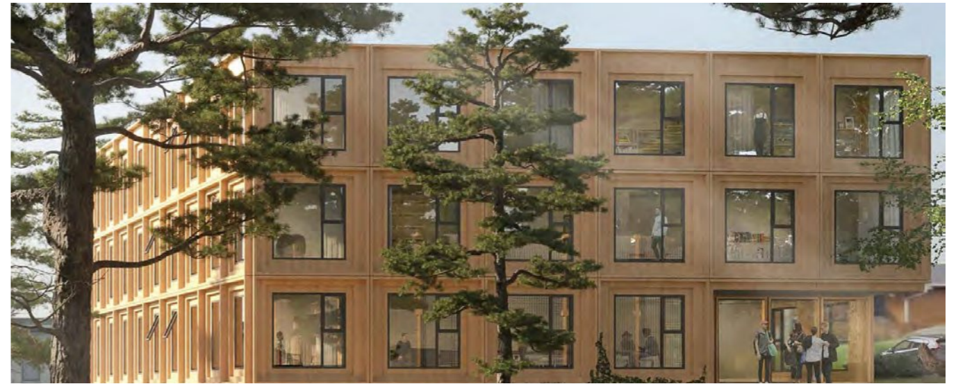
Rasjonell massivtre struktur i tre etasjer
